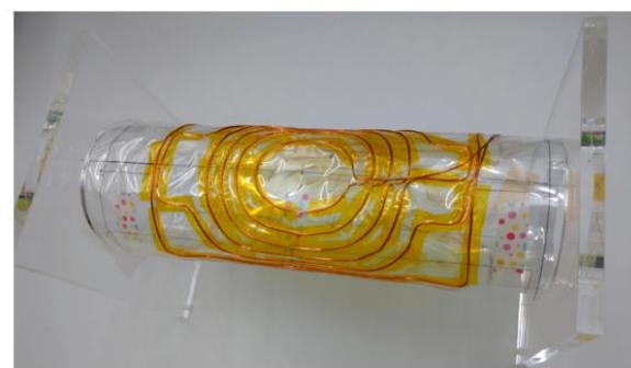
図 4.19 平面で巻いたコイルを治具に巻き付けたシールドコイル
