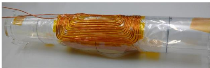
図 4.17 平面で巻いたコイルを治具に巻き付けたメインコイル
